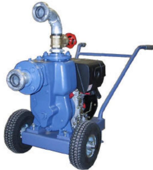
Nach Beendigung des Ansaugvorgangs arbeitet die Pumpe wie jede normalsaugende Kreiselpumpe
